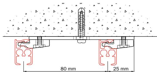
Montage au plafond avec double transporteur 2216 et support plafond 5350
