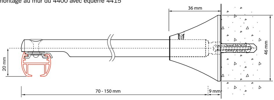
montage au mur du 4400 avec support recoupable 4417
